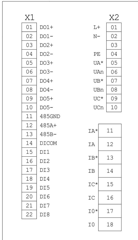
图 5.1 装置电气接线图（-H 和-V 背后端子定义完全相同）
