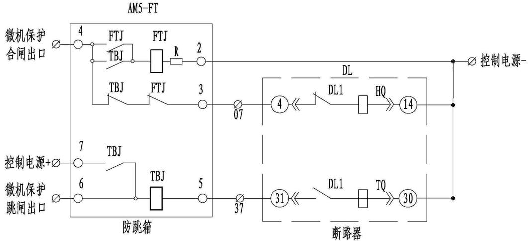
图 1 AM5-FT 防跳模块接线图
